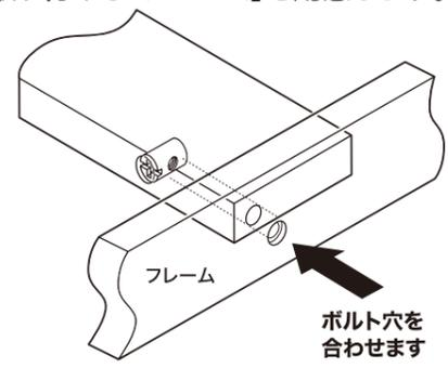
③「マイナスドライバー」で「インサートナット」を押し込みます。その後、微調整しながら「六角ボルト」を差し込みます。
