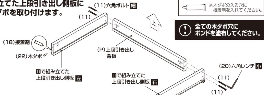
**13** 12で組み立てた上段引き出しに上段引き出し底板を取り付けます。
