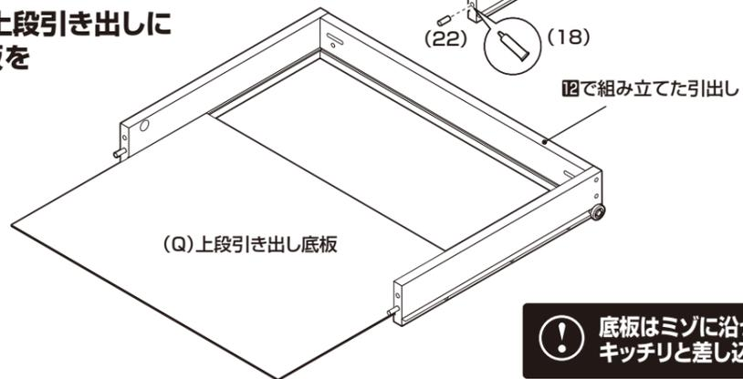
**14** 10で組み立てた引き出し前板を13で組み立てた引き出し本体に取り付けます。
