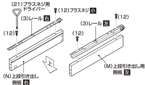
**12** 11で組み立てた上段引き出し側板に背板と木ダボを取り付けます。
