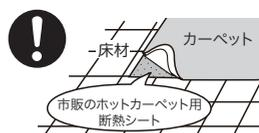
断熱をしないと、床材の変色・変形・割れなどの原因となります。
