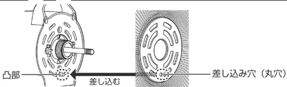
後ガードの差し込み穴（丸穴）を下にして、モーター部前面の凸部に後ガードの差し込み穴（丸穴）を差し込みます。
