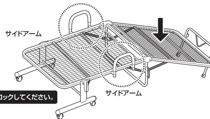
ひらき止めストッパーについて ※開閉作業の際は、必ず前後左右のストッパーピンを抜いてから行ってください。
