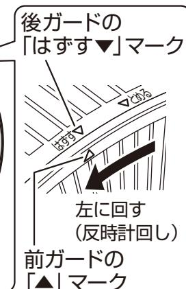
前ガードの「▲」マークを後ガードの「はずす▼」マークに合うまで左に回す(反時計回し)
