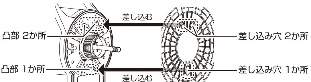
後ガードの差し込み穴が2か所ある側を上にして、モーター部前面の凸部3か所に後ガードの差し込み穴3か所を合わせて差し込みます。
