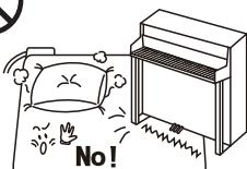
部分的に保温した状態で長時間使用されると、カーペット本体がヒーター線に沿う形で変色し、故障や床面(畳、フローリングなど)の変色・変形の原因となります。また、重い物を長期的に置かれると、ヒーター線が劣化しやすくなります。部分的に温度が高くなり、ヒーター線を傷めて発火したり、異常動作をしたりしてやけどをするおそれがあります。
