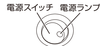
電源「切」の状態 (電源ランプ: 消灯)
