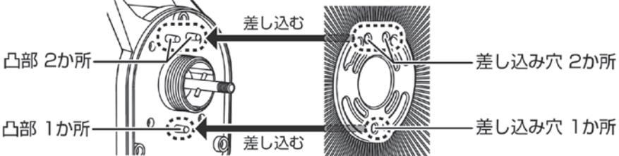
後ガードの差し込み穴が2か所ある側を上にして、モーター部前面の凸部3か所に後ガードの差し込み穴3か所を合わせて差し込みます。
