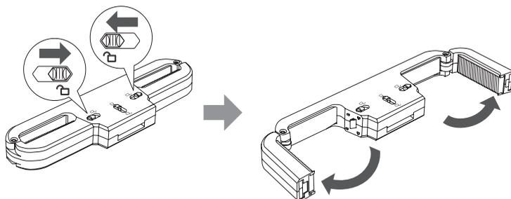
3. アタッチメントのロック部が見える面を上にして、ヘッドレストの支柱をはさみ、ヘッドレスト支柱とアタッチメントのすき間を確認します。
