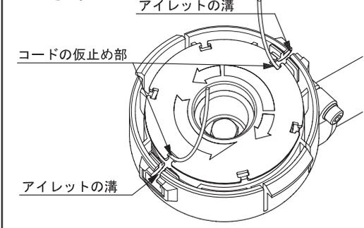
※この時、スライドブロックの凸部にポビンが乗り上げポビンがハウジングから浮かないように注意して下さい。
