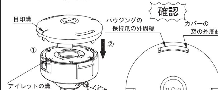
＜▲注意＞ ハウジングの保持爪の外周縁が、カバーの窓の外周縁までほぼいっばいに拵がっていることを確認して下さい。入り込みが不十分のままカッター本体を回転させると、カバーや中の部品が飛散し危険です。
