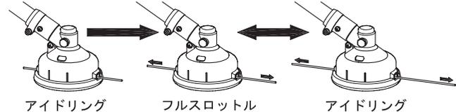
コードが極端に短くなって「2.」の操作を行っても繰りだしされない場合は、コードを使い切ったか、コードの絡み・溶着が考えられます。エンジンを停止し、『3. ナイロンコードの取換え方法』に従い、コードを巻き直して下さい。
