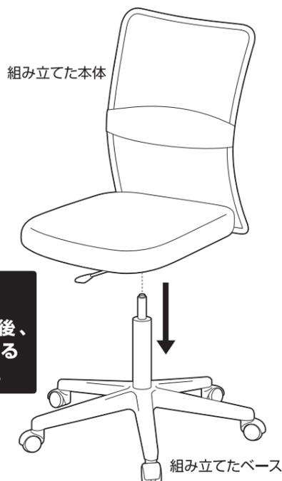
レバーの操作により、座面の高さ調節ができます。
