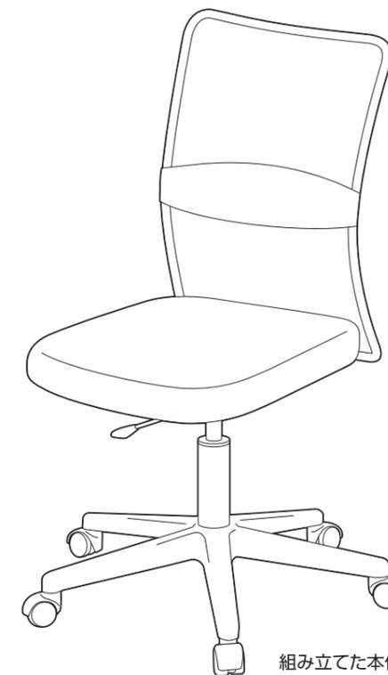
4 ベースにガスシリンダーを差し込み、その上から組み立てた本体を差し込みます。
