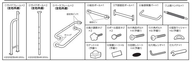
③ベースフレームに④結合ポールを差し込み③ベースフレームに①サイドフレー ムを、⑩六角皿ボルトで固定します。
