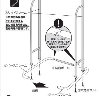
組立ての際には、初めから六角ボルト類をきつく締めないで ください。仮止めするように締め、全ての部品が組み上がった 後に全ての六角ボルトがしっかりと締める様にしてください。
