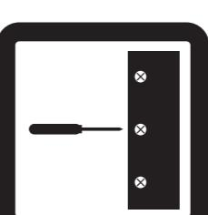
定期的にボルト・ネジ類を締め直してください
