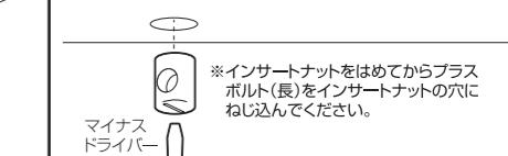
!\*インサートナットをはめてからプラスボルト(長)をインサートナットの穴にねじ込んでください。
