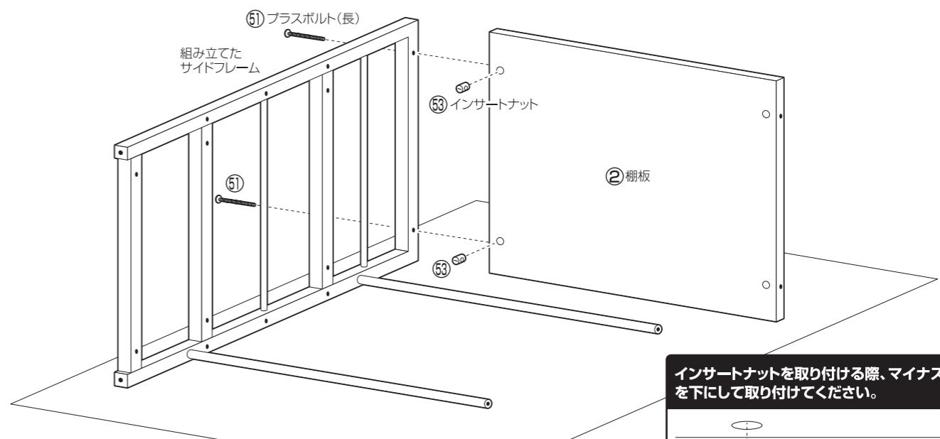
インサートナットを取り付ける際、マイナス面を下にして取り付けてください。
