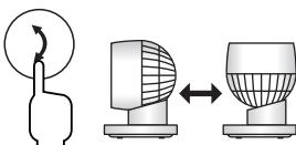
上下首振りボタンを押すと、上下(約90度)に首振り動作し、上下首振りランプが点灯します。
