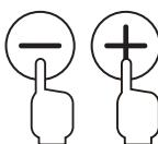
プラスボタンを押すと風量が強くなり、マイナスボタンを押すと風量が弱くなります。風量は5段階の切り換えができ、風量に応じて風量ランプの点灯が増減します。
