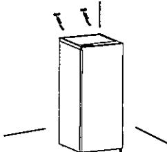
**注意** ● 転倒防止ベルトを固定する壁は、十分な強度があることを確認してください。石こうボードなどに取り付けると、壁を破損するおそれがあります。
