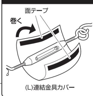
9 組み立てた本体に落下防止カバーを取り付けます。
