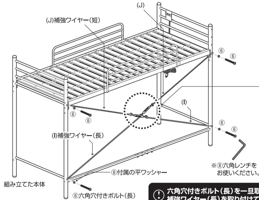
補強ワイヤーを図のように連結金具に引っかけてから、ネジ部分を回して、補強ワイヤーが張るまで締めてください。
