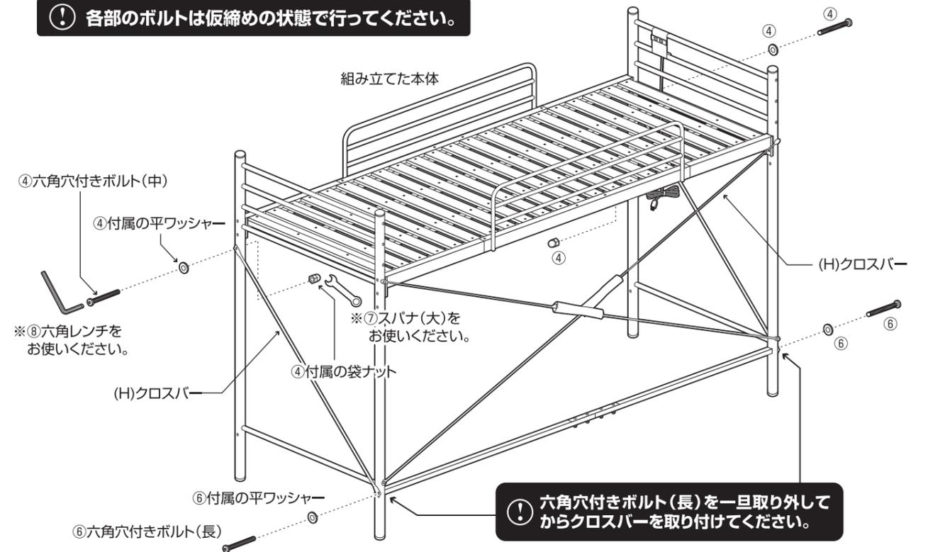
❗ 六角穴付きボルト(長)を一旦取り外してからクロスバーを取り付けてください。
