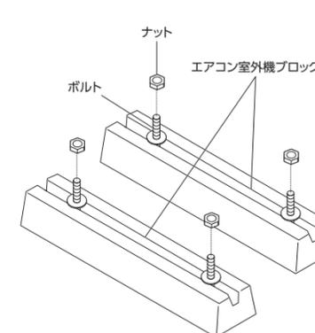
2 ③台座前後板の穴と、⑤台座底板の穴をそろえて、エアコン室外機ブロック付属のボルトを通し、ナットで固定します。
