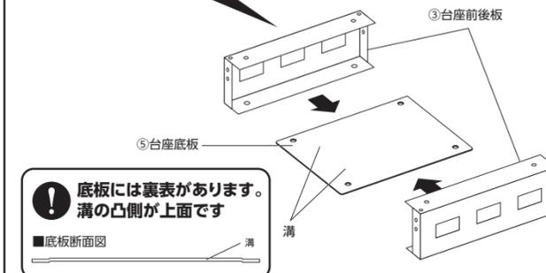
2 ④台座側板を⑦ネジセットで取り付けてください。(8か所)
