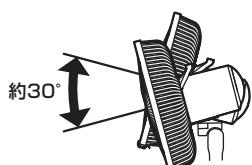
約90°の範囲で左右に 頭振りします。 約30°の範囲で上下に 頭振りします。
