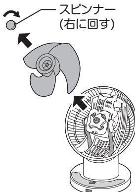
④ガード止めナットを左に回して取り外し、
