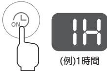
運転停止中に入タイマーボタンを押すと、入タイマー設定ができます。入タイマーボタンを押すたびに入タイマー設定時間がかわり、表示部に設定時間を表示します。
