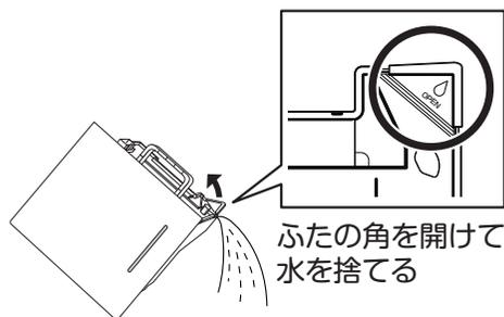
運転中にタンクを取り出すと警告音が鳴って満水ランプが点灯し、運転を一時停止します。
