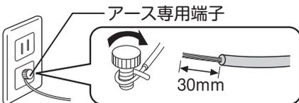
アース線先端の剥きしろを約30mmに切断
