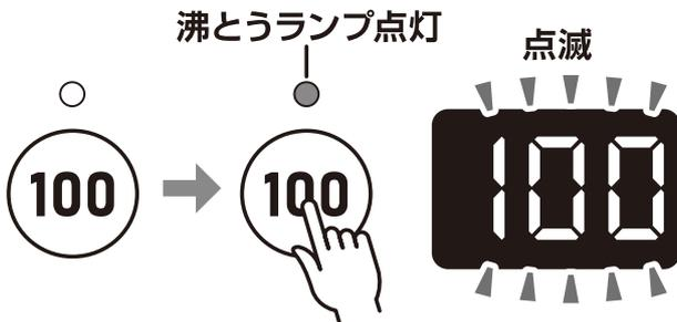
沸とうスイッチをタッチすると、沸とうランプが点灯し、表示部に「100」が点滅表示されます。「100」が5回点滅すると、沸とうが設定されます。
