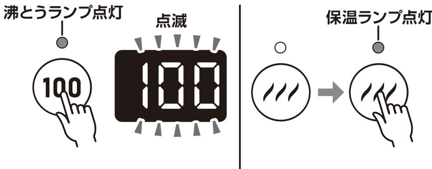
温度を設定後または加熱中や加熱後に保温スイッチをタッチすると、保温ランプが点灯して保温が設定されます。
