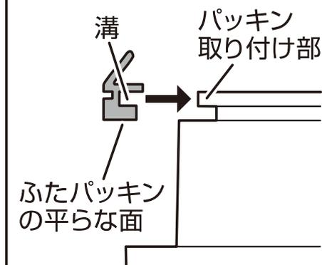
平らな面がふたと接するように下向きにして、パッキンの溝をパッキン取り付け部にはめ込む。
