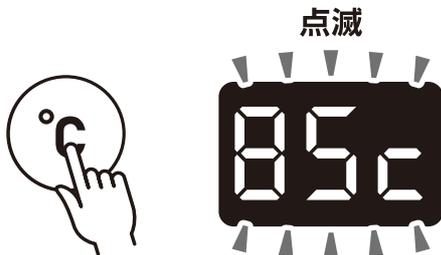
温度設定スイッチをタッチしていくと、表示部に「85c」が点滅表示されます。「85c」が5回点滅すると、温度が設定されます。
