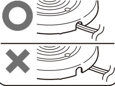
必ず結束バンドを外して、電源コードをのぼす。電源プラグを真っ直ぐ差し込む。
