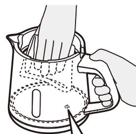
ケトル内側にある温度センサーに強い力や衝撃を与えると、故障（温度を感知できないなど）の原因になりますので、十分注意してお手入れする。
