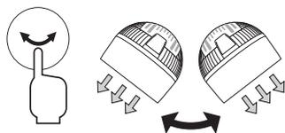
左右首振りボタンを押すと、左右首振りランプが点灯し、左右(約75度)に首振り動作します。再度押すとランプが消灯し、首振りが停止します。
