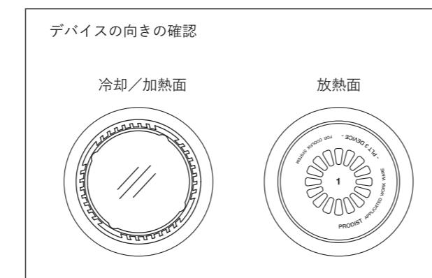
2 ベスト内側からみて、以下の図の配置でペルチェデバイスを取り付けます。
