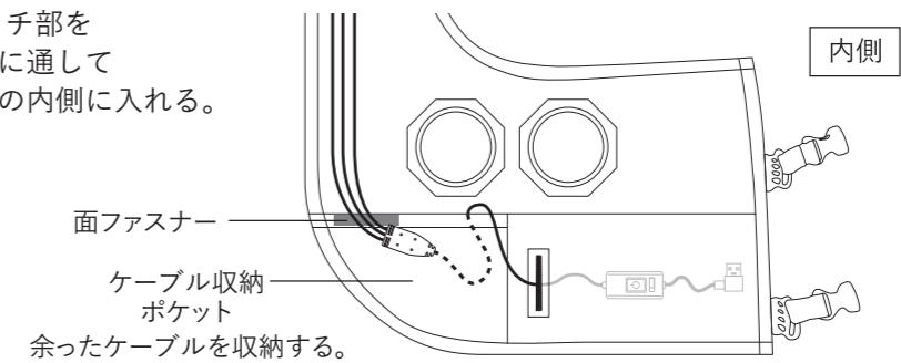
4 バッテリーを接続し、バッテリーポケットに収納する。
