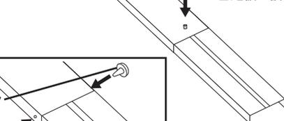
固定板を縦向きにして、窓パネルBの溝に合わせる
