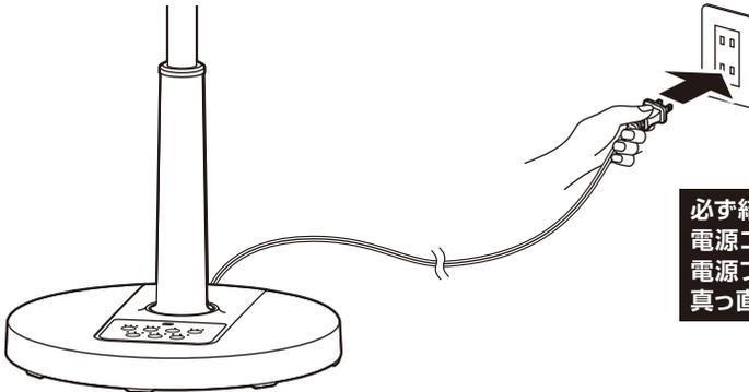
必ず結束バンドを外して、電源コードをのぼす。電源プラグをコンセントに真っ直ぐ差し込む。
