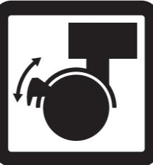
定期的にボルト・ネジ類を締め直してください
